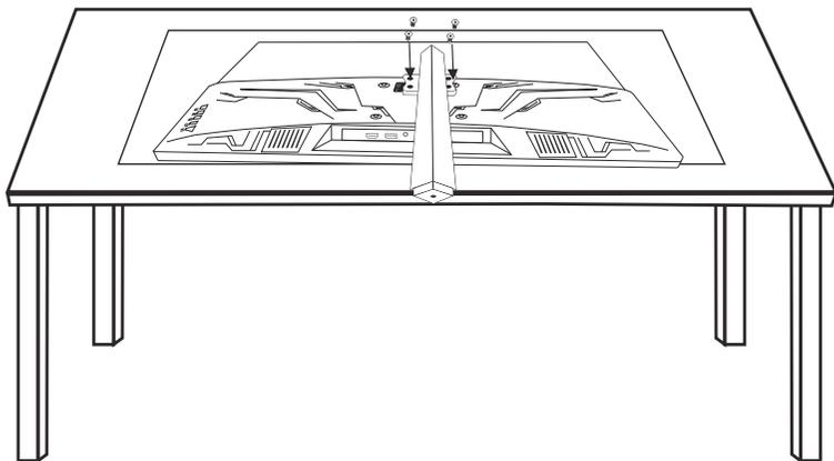
3. Fixe a base no suporte instalado com o parafuso para a base e aperte com uma chave de fenda, tendo como referência a imagem abaixo. Então, levante o monitor segurando no suporte e coloque-o na vertical sobre a mesa.
